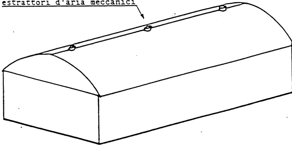
DIS. 8 : Installazione di estrattori d'aria su edifici con copertura a volta.
